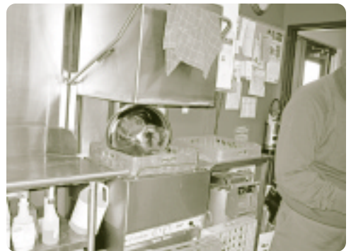
> Ce modèle permet de glisser les paniers vers le lave-vaisselle plutôt que de les soulever. Il lave aussi les gros chaudrons sans problème (CPE Saint-Luc).
