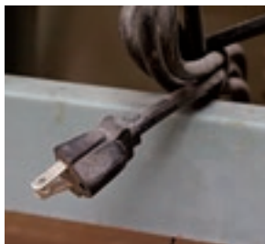
Isolation du fil électrique déficiente et absence de la troisième branche de mise à la terre : des situations à corriger immédiatement.
