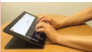
Taper un texte sur la tablette inclinée n'est pas recommandé. Les contraintes sont importantes pour les poignets.
