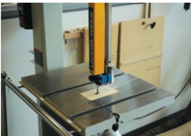
Sur une scie à ruban, il faut ajuster le garde avant chaque utilisation.
