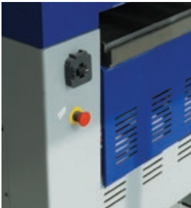
Banc de scie. Pour bloquer l'accès aux pièces en mouvement, une machine doit être munie d'un garde (RSST, art. 208 : un garde est un protecteur).
