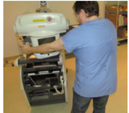
3. Une des grandes difficultés réside dans la force requise pour déplacer latéralement le tube, ce qui entraîne une torsion du dos.
