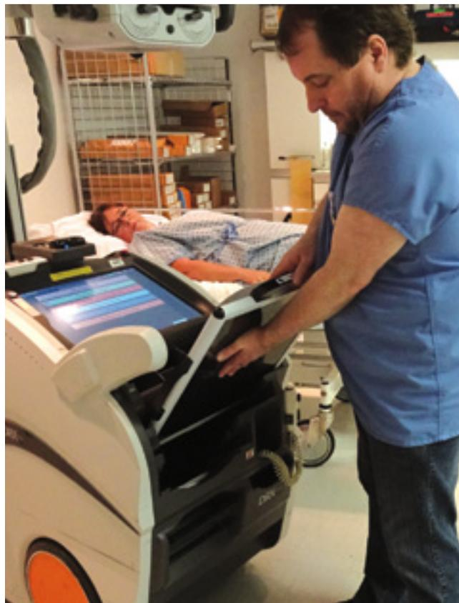
6. Pour limiter les efforts en abduction, le technologue utilise ses deux mains pour manipuler le détecteur. D'une main, il glisse le détecteur dans son socle et, de l'autre main, il le maintient pour ensuite l'appuyer sur l'appareil. Ainsi, il conserve une position plus neutre pour les bras.
