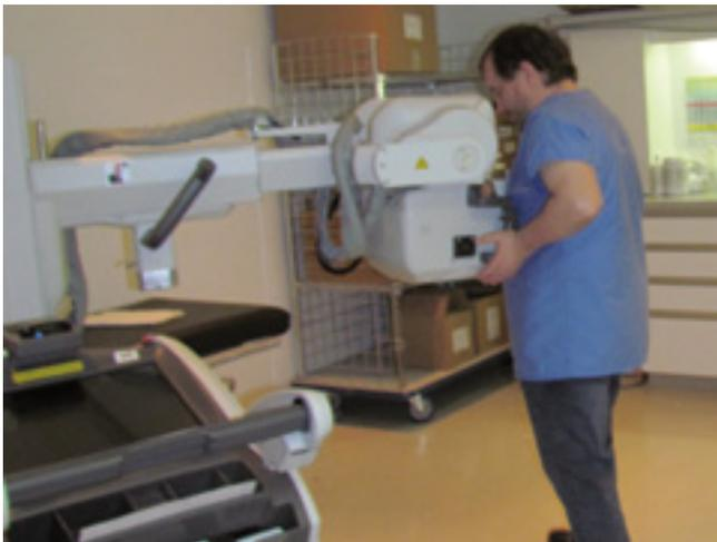
10. Il faut manipuler le tube le plus longtemps possible proche de soi, avant de l'élever au-dessus de la zone à exposer.
