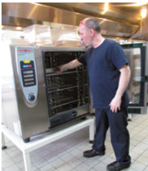
5. Le support du four est abaissé. Le travailleur prend les panes à une bonne hauteur (entre les genoux et les épaules).
