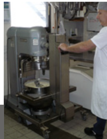
3 et 4. Le connecteur pour abaisser le levier (à gauche). Le levier soulève le bol sans effort (à droite).
