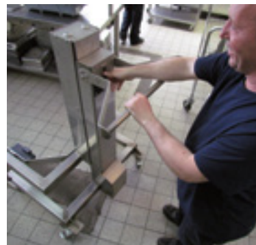
3 et 4. Le connecteur pour abaisser le levier (à gauche). Le levier soulève le bol sans effort (à droite).
