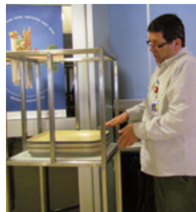
6. Les plateaux déposés sur une tablette à 20 cm du sol (à droite) sont à 89 cm sur le nouveau chariot (à gauche). Celui-ci est aussi utilisé à la laverie, près de la courroie mécanisée.
