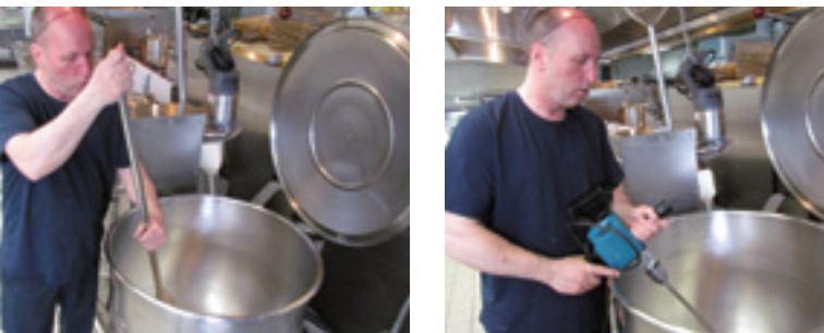
1 et 2. Contrainte au haut du dos pour émietter la viande avec une rame (à gauche). La perceuse et le fouet ont remplacé la rame manuelle (à droite). L'équipement s'appuie partiellement sur le rebord de la marmite, limitant les positions fixes et contraignantes.
