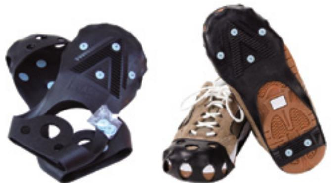
*Les crampons VGet-A-Grip : la lettre « V » réfère à la forme du relief et la disposition des crampons sous la semelle. Six courtes pointes en carbure de tungstène de 1,5 mm de longueur rendent les semelles antidérapantes. Disponibles en quatre grandeurs pour les femmes et les hommes.*
