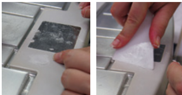
2. Particules de paraffine refroidies lors de l'inclusion sur l'appareil et nettoyage avec un grattoir.
