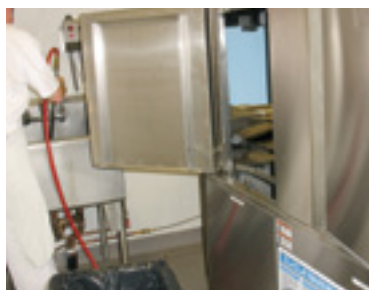
Dans le local du lave-vaisselle, une cuve, un boyau avec jet d'eau et une poubelle permettent de procéder au nettoyage de l'appareil. Des modifications aux ouvertures latérales des portes donnent un meilleur accès aux diverses zones à nettoyer à l'intérieur de l'appareil.
