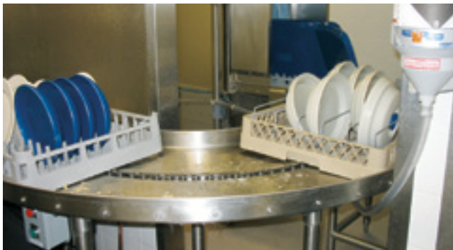
1. Entrée du lave-vaisselle, convoyeur rotatif et chapelet de paniers.
