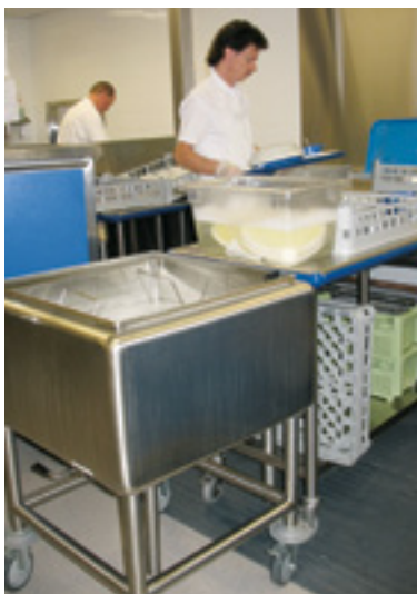
2. Poste de débarassage : chaque personne dispose d'une table sur roulettes et des paniers vides de vaisselle et d'ustensiles sont rangés dessous. La surface du chariot permet de placer deux paniers pour recevoir des pièces de vaisselle particulière, un panier pour les ustensiles et un contenant pour le trempage de certains articles.
