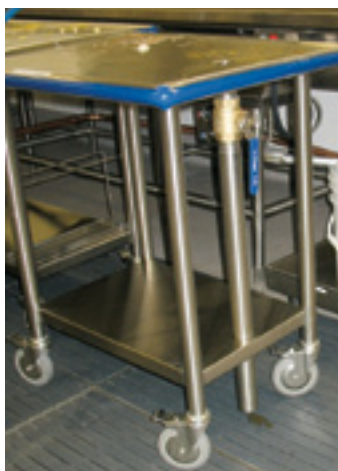
Ces tables sont conçues pour faciliter les manipulations : tuyau de drainage pour évacuer l'eau, mécanisme d'ouverture du drainage, roulettes pivotantes avec freins.
