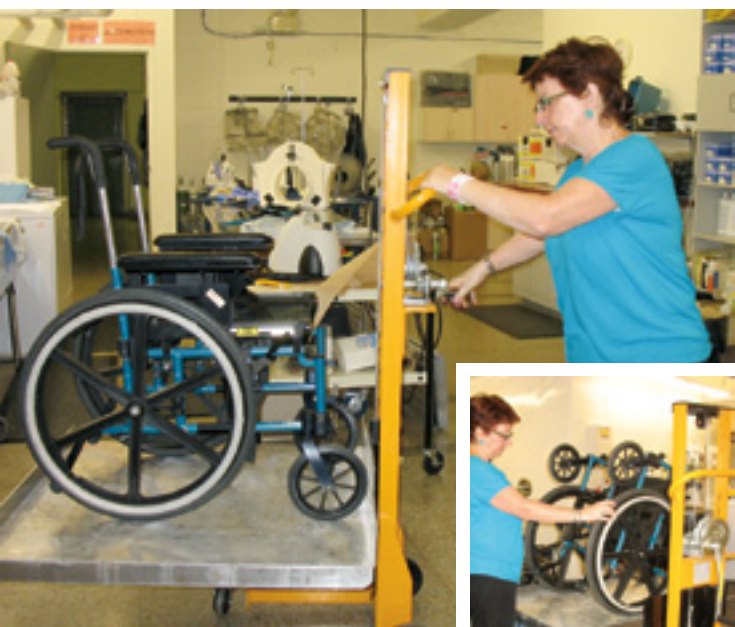
2. Une manivelle permet les ajustements de la hauteur de la plateforme aménagée par le Service des installations matérielles.
