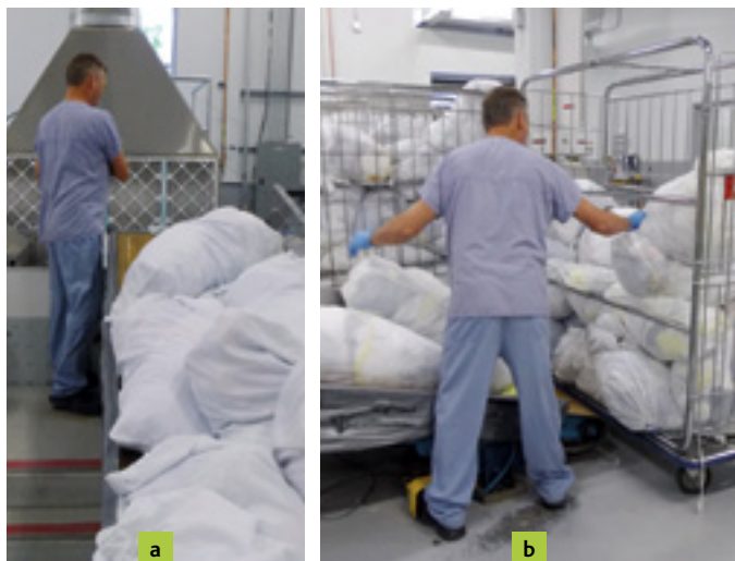
2. Poste de buandier : les poches sont placées sur le convoyeur (a) et vidées dans le convoyeur de chargement (b).
