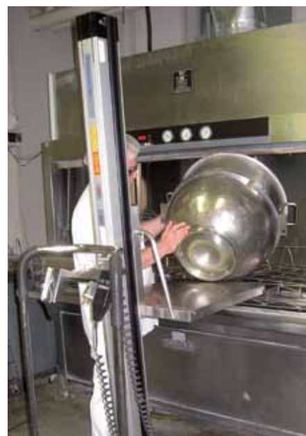
7. La plateforme élévatrice (41 x 51 cm) descend plus bas que la base du malaxeur, ce qui permet d'y glisser le bol.
