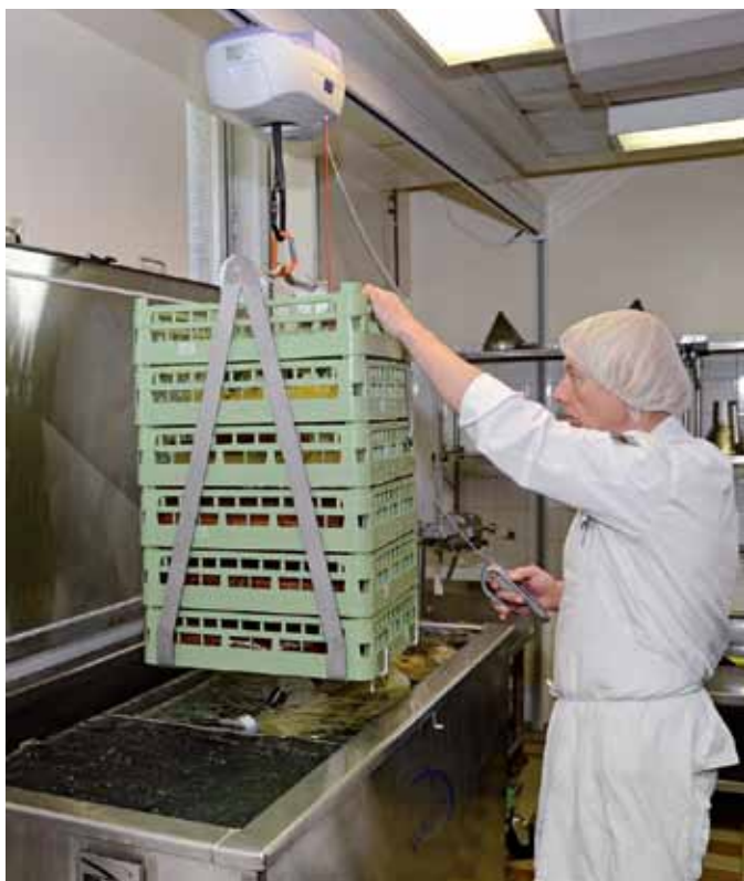
3. Le lève-personne sur rail au plafond (BHM) s'accroche à la poignée du support pour lever, insérer et sortir le support de la cuve de refroidissement. Un support et six paniers pleins pèsent 90 kg (198 lb). À la sortie, le support est déposé sur la base à roulettes.
