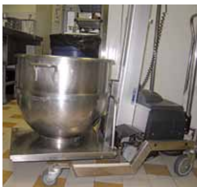
7. La plateforme élévatrice (41 x 51 cm) descend plus bas que la base du malaxeur, ce qui permet d'y glisser le bol.
