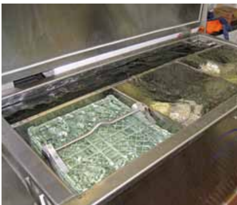
3. Le lève-personne sur rail au plafond (BHM) s'accroche à la poignée du support pour lever, insérer et sortir le support de la cuve de refroidissement. Un support et six paniers pleins pèsent 90 kg (198 lb). À la sortie, le support est déposé sur la base à roulettes.
