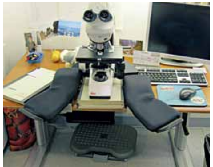
1. La table ajustable au laboratoire de cytologie contribue à la réduction des TMS.
