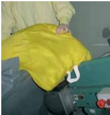
8. Certaines personnes retournent le bac afin de saisir les poches de plus près et éviter le travail à bout de bras en portant la charge. Les poches lourdes ou mouillées sont déposées sur le rebord du bac et basculées sur la courroie.
