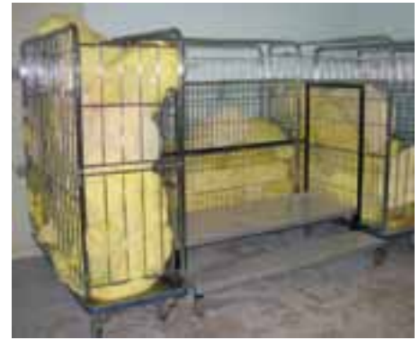
2. Chaque poche de linge doit être passée par-dessus la barre supérieure du chariot métallique à une hauteur de 1,30 mètre (51 po). Les poches mesurent 71 x 96 cm (28-38 po), pèsent entre 10 et 23 kg (22-50 lb) et sont parfois mouillées.
