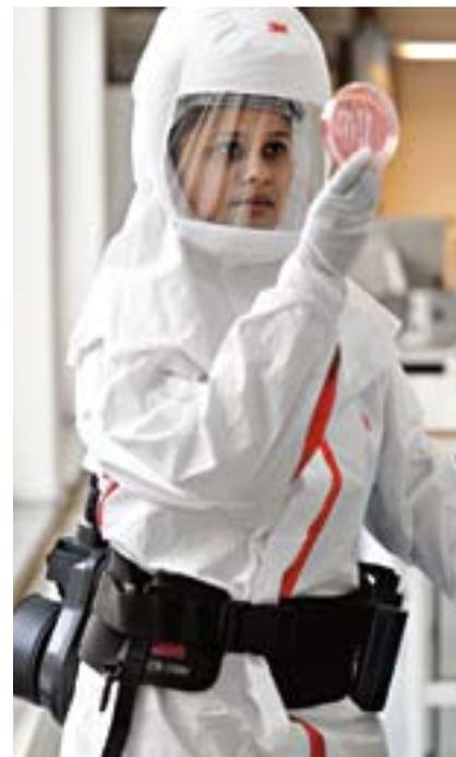
3. Respirateur d'épuration d'air propulsé à ajustement lâche ou serré.
