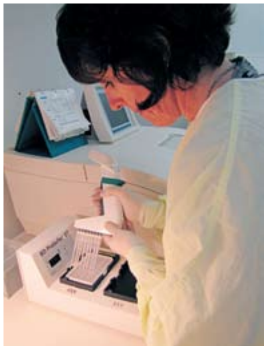
4. Les pipettes multicanaux permettent d'aspirer et de délivrer les liquides dans plusieurs puits en une seule action.
