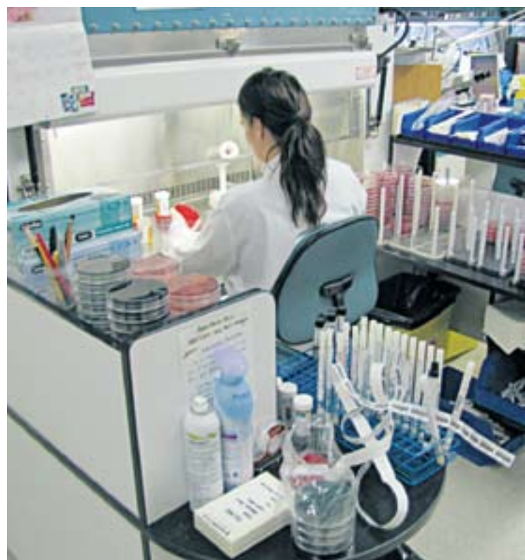
Enceinte biologique à flux laminaire ajustable en hauteur, laboratoire de microbiologie : inusitée, fonctionnelle et très sécuritaire pour le personnel quiensemence les géloses, cette enceinte est déposée sur une surface de travail en « U », ajustable en hauteur de manière électrique. La surface à droite de la botte peut être approchée ou éloignée et permet à chaque utilisateur de placer les accessoires à portée de bras. L'espace est dégagé sous le comptoir de gauche, ce qui facilite la préparation des géloses et autres spécimens.
