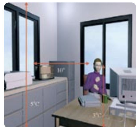
1. Illustration du gradient de température pied-tête (3 °C max), de l'asymétrie horizontale (10 °C max) et l'asymétrie verticale (5 °C max) (schéma : site Internet de OSHA).
