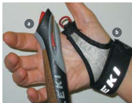
Photo 1. Système d'attache : a) Poignée du bâton de marche nordique munie d'un bouton et d'une ouverture pour fixer l'anneau du gantelet. b) Gantelet (dragonne) muni d'un anneau qui s'insère dans la poignée du bâton et d'une attache en velcro.
